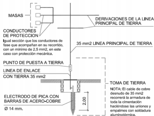
ESQUEMA DE PUESTA A TIERRA
